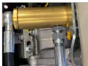
IL RIDUTTORE DI VELOCITÀ IDRAULICO RIDUCE I GIRI DEL MOTORE QUANDO LA POMPA È IN FASE PY-PASS.
