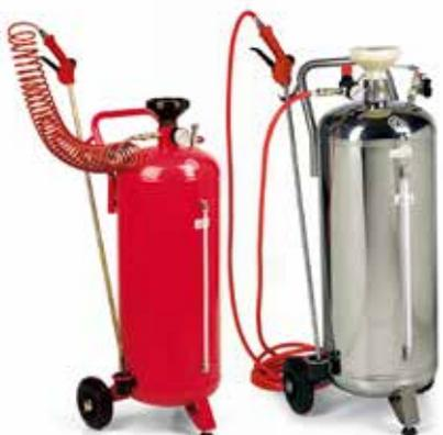
Per la nebulizzazione dei detergenti prima del lavaggio. La spinta per l'erogazione è data dall'aria compressa prelevata da una fonte esterna. Il riempimento aria deve essere fatto nella fase iniziale e dura fino ad esaurimento del prodotto. I nebulizzatori sono provvisti di: indicatore di livello del prodotto chimico, indicatore di pressione aria (max 6bar) e valvola di sicurezza.
