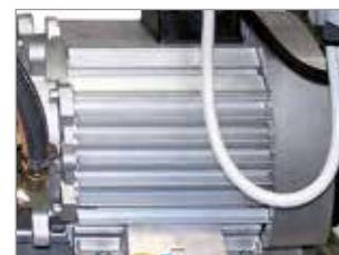
MOTORE ELETTRICO RAFFREDDATO AD ARIA CON PROTEZIONE TERMICA CHE INTERVIENE NEL CASO DI SOVRACCARICO DI CORRENTE.
