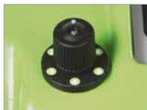
MANOPOLA PER LA REGOLAZIONE DELLA PORTATA VAPORE, PANNELLO QUADRO ELETTRICO "TOUCH" CON PROTEZIONE CONTRO L'UMIDITÀ.
